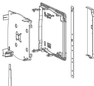
Coefficient de transmission thermique :  $U_c$  (W/m.K) = 1.34 (pour un coffre de 1m40) / Perméabilité à l'air : Classe C3 = 6.92 m<sup>3</sup>/h à 300 Pa / Affaiblissement acoustique :  $D_{n,e,W}$  (C;Ctr) = 43 (-1;-3) dB
